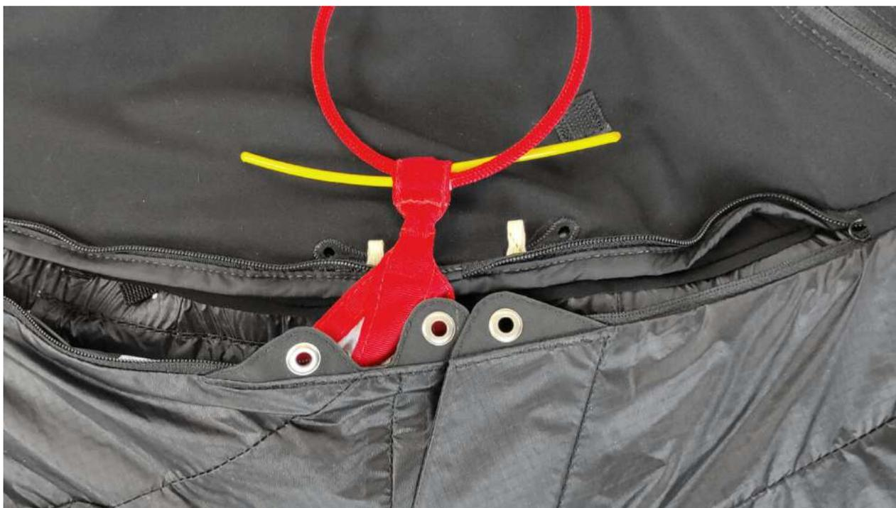
4. Tirer les boucles blanches à travers les œillets de fermeture en utilisant l'aide au pliage et les fermer avec le câble jaune. Ranger ensuite les câbles jaunes dans les boutonnières.
