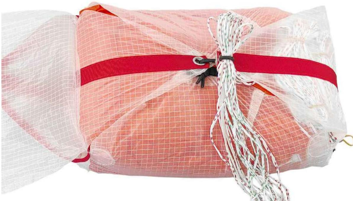
Ferme le dernier rabat du conteneur à l'aide de deux boucles de suspentes d'égale longueur (5 à 6 cm). Ces boucles finales sont tenues par des élastiques doubles qui passent par les oeillets du rabat externe du conteneur. Les deux élastiques sont pré-montés en usine.
